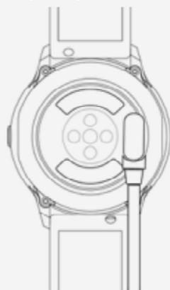
\*Ein Magnet im Ladekopf führt das Ladegerät in die richtige Position. Die beiden Kontakte des Ladekabel sollten nicht gezwungen werden, sich in entgegengesetzter Richtung mit dem Leiter zu verbinden, da dies zu einem Kurzschluss führen kann.
